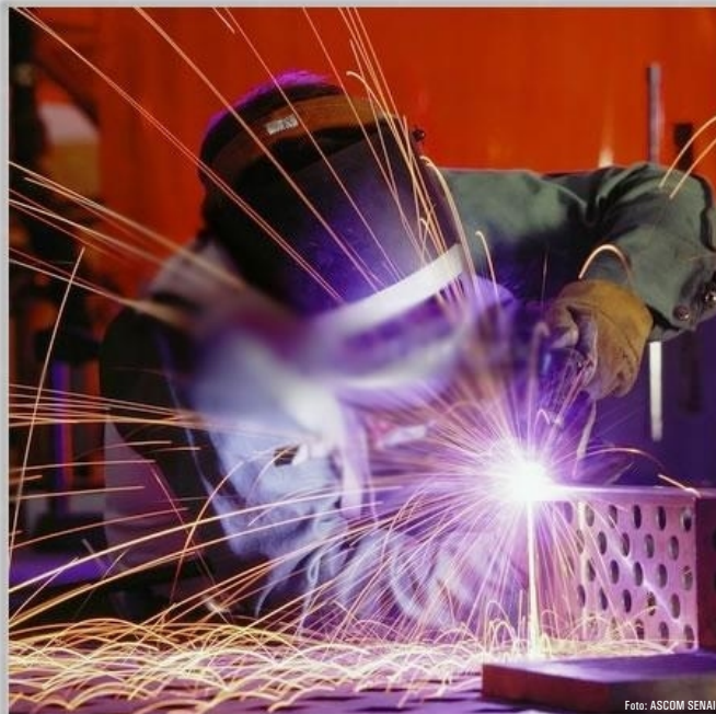
Profissional realizando processo de solda em MIG/MAG
